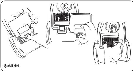
6. H.E.P.A. filtreyi çok kirli ise çöp tenekesinin üzerinde silkeleyiniz, gerekirse akan suyun altına tutarak yıkayabilirsiniz. Bu durumda filtreyi en az 24 saat kurutmanız gerekiyor.
