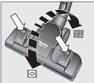
**⚠** Si le parece que la fuerza de deslizamiento del cepillo universal AirTeQ es demasiado alta, reduzca la potencia de aspiración hasta que el cepillo universal se deslice suavemente (véase capítulo "Seleccionar manejo - potencia de aspiración").
