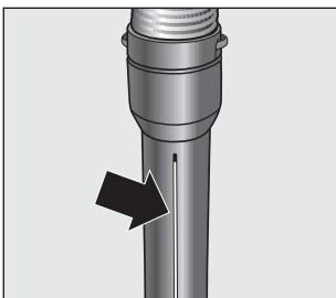
**⚠** Al aspirar especialmente polvo fino como polvo procedente de taladros, arena, escayola, harina, etc., se generan cargas electrostáticas que pueden descargarse en determinadas situaciones. A fin de evitar la sensación desagradable que producen dichas descargas se ha colocado un revestimiento metálico en la parte inferior del mango. Por este motivo, al aspirar, preste atención a colocar las manos siempre en este revestimiento metálico.
