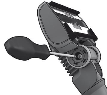
**3. คลายสกรูแกนล้อและทำความสะอาดทุกส่วน ประกอบเข้าไปใหม่ในลำดับย้อนหลัง**
