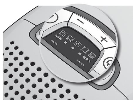
9. 调节吸力。带手动调节功能的型号：按 +/- 按钮调节吸力。
