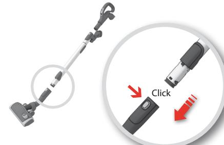
**Bevestig de telescopicbuis aan het mondstuk** (om deze weer te verwijderen, drukt u op de ontgrendelknop en trekt u het mondstuk los).
