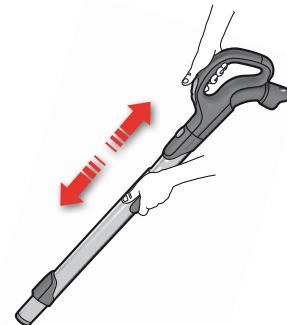
Отрегулируйте telescopicую трубку, держа замок одной рукой и вытягивая рукоятку другой.
