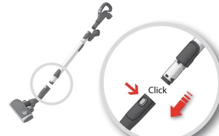
**Acople el tubo telescopico en la boquilla para suelos** (para retirarlo, presione el botón de bloqueo y tire de la boquilla hacia afuera).
