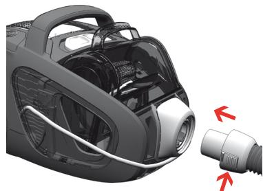
Вставьте шланг (чтобы снять шланг, нажмите кнопки-фиксаторы и вытяните его).
