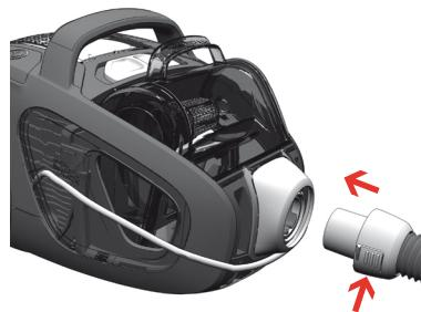
**Inserire il tubo flessibile** (per rimuoverlo, premere i pulsanti di rilascio ed estrarre il tubo).
