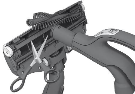
Τραβήξτε προς τα έξω τη βούρτσα-ρολό και αφαιρέστε τυχόν μπλεγμένες κλωτές κόβοντάς τις με φαλιδί. Χρησιμοποιήστε τη χειρολαβή του εύκαμπτου σωλήνα, για να καθαρίσετε το ακροφύσιο. Τοποθετήστε τα ξανά ακολουθώντας τη διαδικασία αντίστροφα.
