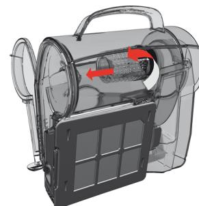
Retire el filtro ciclónico tirando hacia afuera de la sujeción del filtro.
