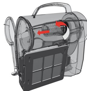
Per rimuovere il filtro ciclonico, estrarre il dispositivo di tenuta del filtro.
