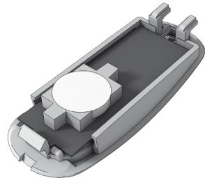
Utilice exclusivamente pilas de tipo LITHIUM CR2032. Se deben quitar las pilas del aparato antes de desecharlo, y su vertido deberá realizarse de forma segura.
