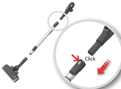
**Acople el tubo telescopico al asa del tubo** (para retirarlo, pulse el botón de bloqueo y tire del asa hacia afuera).
