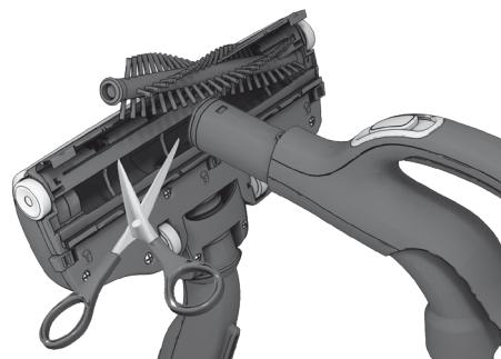
Extraiga el cepillo de rodillo y retire las fibras enganchadas cortándolas con unas tijeras. Utilice el asa del tubo flexible para limpiar la boquilla. Realice el montaje en orden inverso.
