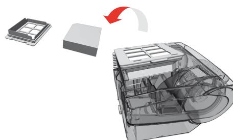
Pulire il filtro in espanso ogni 3 - 4 mesi o quando è visivamente sporco. Lasciarlo asciugare 6 - 12 ore prima di riporlo nell'aspirapolvere.
