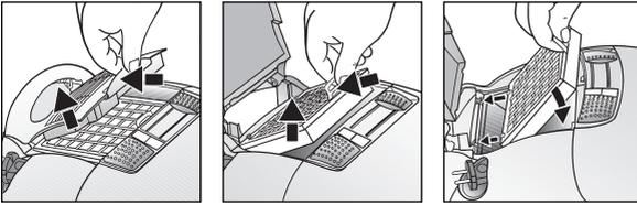
Ist Ihr Gerät mit einem Hepa-Filter ausgestattet, muss dieser jährlich ausgewechselt werden.
