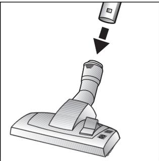
Teleskoprohr bis zum Einrasten bündig in den Stutzen der Bodendüse schieben.
