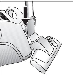
Bei kurzen Saugpausen können Sie die Parkhilfe an der Geräterückseite benutzen. Kunststoffrippe am Düsenstutzen in die Aussparung an der Geräterückseite schieben.
