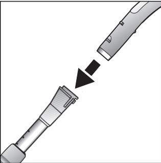
Handgriff bis zum Einrasten bündig in das Teleskoprohr schieben.
