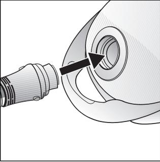
Saugschlauchstutzen in die Saugöffnung einführen und einrasten lassen.
