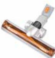
Turbo süpürme uçları, içinde süpürgenin geçtiği hava ile çalışan bir turbo türbin, buna bağlanmış spiral firçadan oluşmaktadır. Emilen hava türbini gevirmekte, dönen türbin hava yardımıyla螺旋firçayı döndürmektedir. İki yandan yataklanmış firçada dönerek tozları havalandırıp emmektedir.
